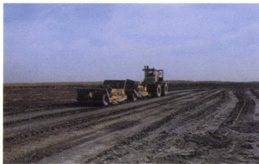
10. Kotrás önjáró szkréperládás munkagéppel. Fülöpszállás, Fehér-szék (Boros Emil)
